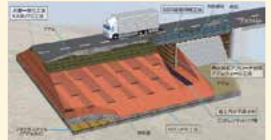
ジオテキスタイルを用いた道路盛土の耐震化工法の適用イメージ
