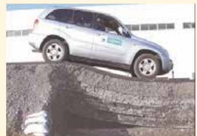
実物大性能確認実験状況(強制沈下量550mm)
