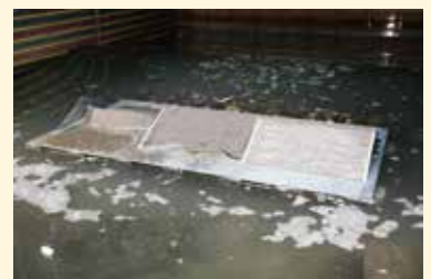
中型越流試験(左から砂、一般的な堤体土、砕・転圧土)
