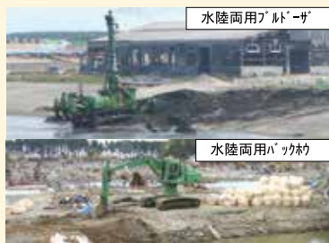
無線遠隔操縦式水陸両用ブルドーザ 水陸両用バックホウ
