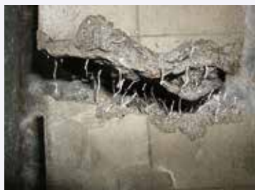
※曲げタフネス試験破断状況。鋼繊維でねばり強い構造体を実現。
