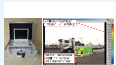
音カメラ システム全景と測定画面
