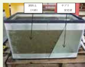
川砂とサブリア安定液を充填した後、孔壁面の安定性を確認
