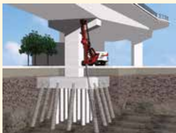
橋梁基礎の耐震補強
